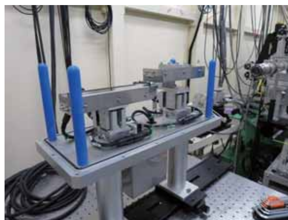
図2 (+)配置に設置した2枚のミラー。上流側(左側)ミラーは上面でX線を反射し、下流側(右側)ミラーは下面で反射する。
