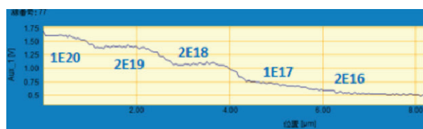
図 1 AC(Tapping) mode SMM によるキャリア濃度測定結果の一例：キャリア濃度が小さいほど空乏層が拡がり、それにより depletion capacitance が減少するのでロックインの振幅 V も減って行く。
