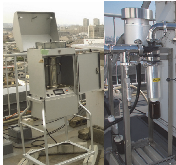
図1 大気粒子状物質採取装置
