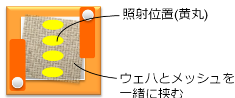
Fig 2. 照射時のサンプルセッティング
