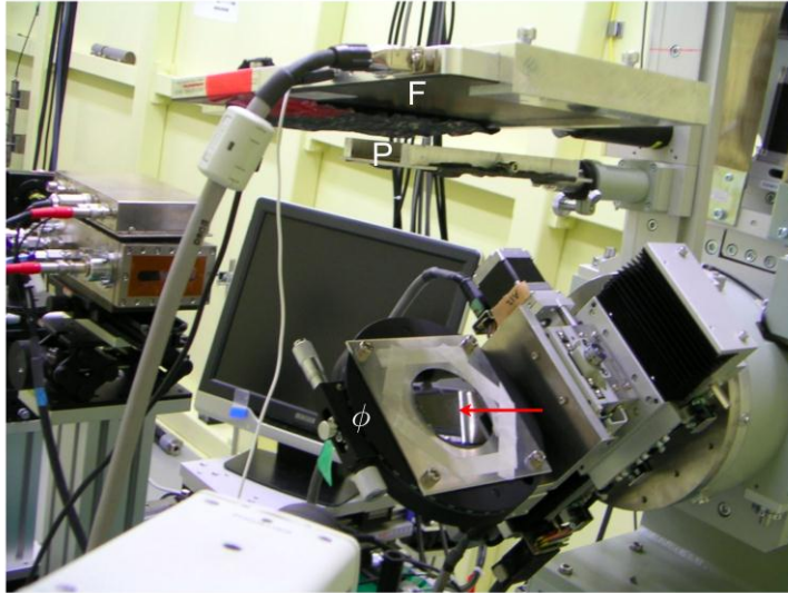
図 1 実験配置。赤矢印は試料に入射するX線の方向を示す。アルミニウム製の試料ホルダーは面内回転ステージ ( \phi ) 上に設置されている。 F: フラットパネルセンサー P: 原子核乾板ホルダー
