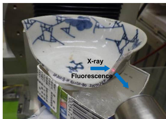
図 2. 皿出土した「好生館」の小碗(755_NNN30_0123_西中野遺跡)のシンクロトン蛍光 X 線分析測定。レーザー光で光っている箇所 X 線が左側から照射され、発生した蛍光 X 線が手前の検出器に達し、蛍光 X 線スペクトルが得られる。
