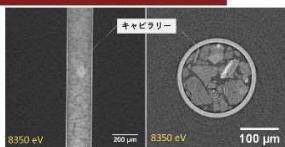
図2 As prep試料 (a) 2次元透過像 (b) 再構成断面像
