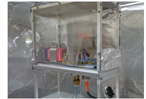
図2 (左) XANES測定用グローブボックス (右) 試料設置位置
