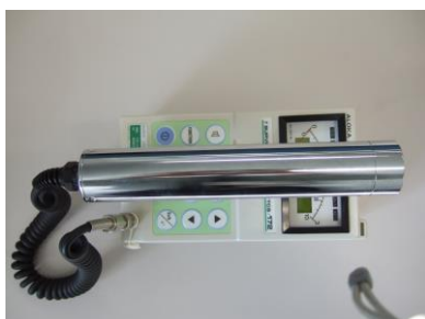
(シンチレーション式サーベイメータ)
