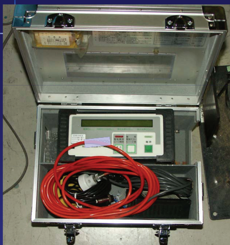
可燃性ガス・CO・H 2 S・O 2 (ハッチ内のモニター用)
