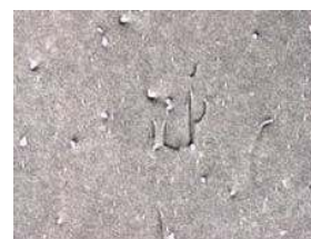
欠陥があるところには周囲と比べてコントラスト変化が生じる。
