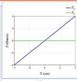
最大で、2T/mのSkew 4極磁場成分が生成され、ビームサイズ調整に十分である。
