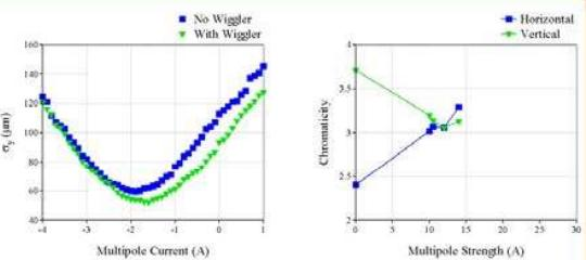
多極成分電磁石により、垂直方向ビームサイズを調整した様子（左図）。最小で52 μmまでビームサイズが調整できることがわかった。
