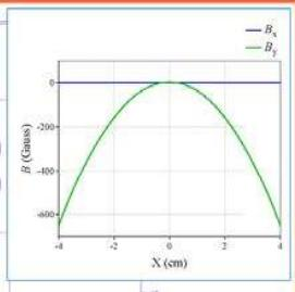
最大で、40 T/mの6極成分が生成され、クロマティシティ補正に十分な能力がある。
