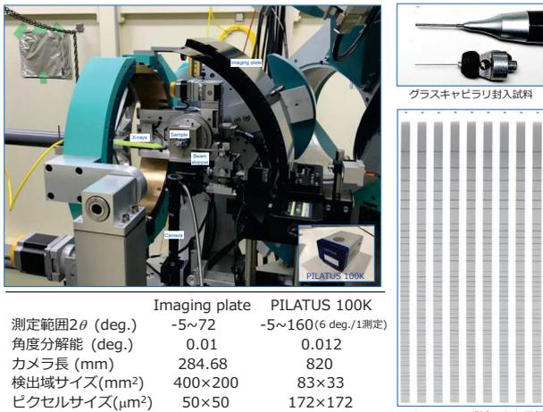
多軸回折計上に デバイセラー法を用いた粉末回折実験設備 を構築した。直径0.1 ~ 0.2 mm $\phi$ のグラスキャピラリーに封入された粉末結晶に放射光を照射し、回折強度分布を2次元検出器[Imaging plate(IP)、またはPILATUS]で測定する。
