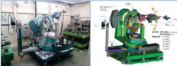
実験ハッチ2には、主に薄膜回折・微小角入射X線回折(GIXD)を目的とした多軸回折装置(Huber社製)が設置されている。X線検出器としてシンチレーションカウンタ(NaI, Yap), 2次元検出器(PILATUS 100K)を使用できる。
