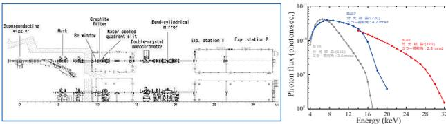
電子蓄積リング直線部の4テスラ超電導ウィグラーを挿入光源とするビームライン。偏向磁石部を光源とするビームラインより高エネルギーのX線を高強度で利用できる。X線は2結晶分光器[分光結晶Si(220)]で分光され、視射角2.3 mradの湾曲円筒型ミラーにより実験ハッチ2に集光される。
