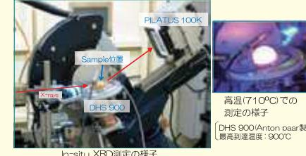
In-Ga-OInGa:2:1系アモルファス薄膜の加熱による結晶化過程の測定において、従来のXRD測定では、加熱前後の測定のみであった。PILATUS 100K(Dectris)製とDHS 900(Anton Paar)製を用いることで、結晶化過程のIn-situ測定に成功した。
