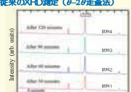
試料1 : 30分加熱→除冷→XRD測定
