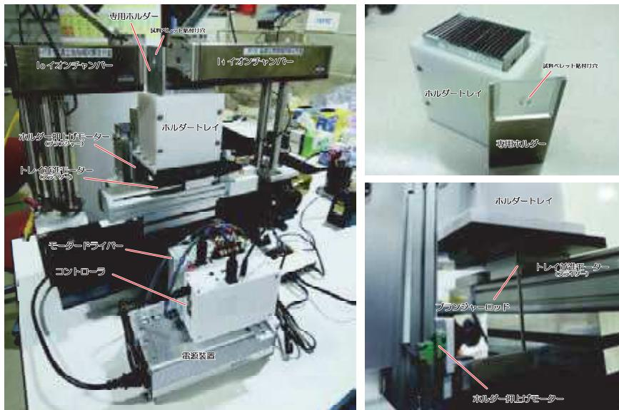
透過XAFS用自動試料交換システム“DominoBox”では、試料ペレットを高い寸法精度と平行・平滑度(数十ミクロン以下)で加工された専用ホルダーに貼り付けてトレイにストレージする点に特徴がある。ホルダー表面はテフロン処理が施されており、ホルダー同士を密着させて重ねた状態から中の1枚だけを滑らかに取り出すことが可能である。これによりホルダー自体が隣のホルダーのガイドとして機能し、ガイドレールや精密位置決め機能が不要で、非常にコンパクトなサイズ(～150mm)に21枚の試料ペレットをストレージすることが可能となっている。また、ホルダーが滑らかに動くため、「ホルダーをプランジャーで押し上げて測定位置へセット」「プランジャーを戻すとホルダーが自重だけで元位置まで落ちて退避」することが可能であり、他の同等システムで用いられている『試料を掴む』機構が不要となっている。
