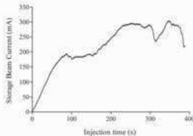
ユーザー運転日における入射不調の様子
