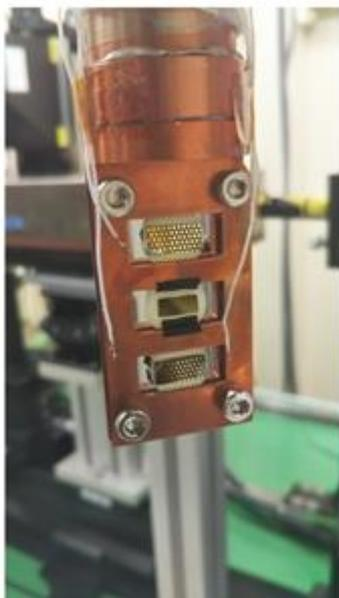
図2：オペランド XAFS 測定のセットアップ。導線により電圧印加を行うことができる。
