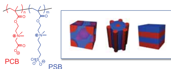
図 1 PCB- b -PSB の化学構造と水溶液が形成するメソ構造の模式図
