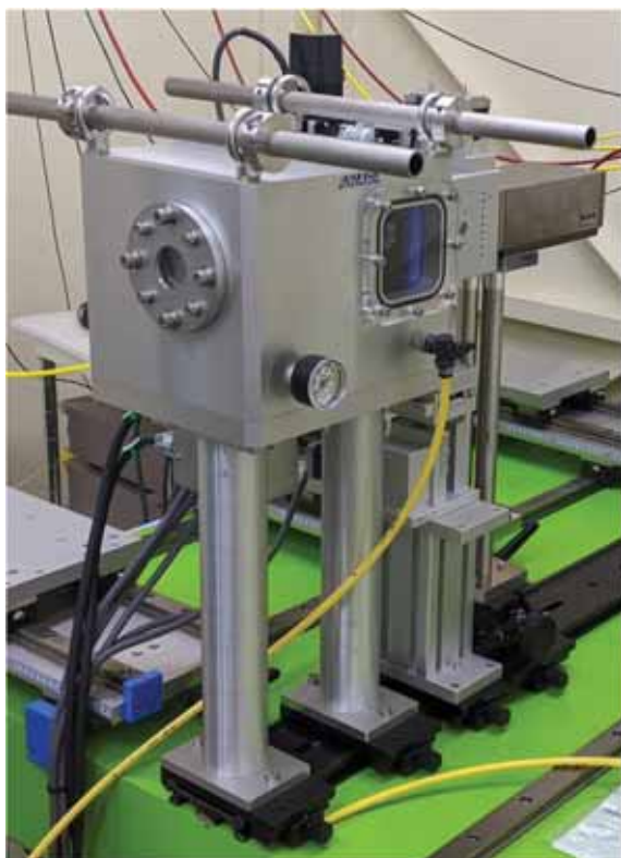
図4 高調波除去ミラーチャンバー
