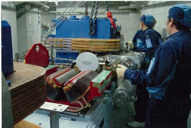
図5 蓄積リング真空チャンバー設置状況(2004年2月)。偏向電磁石内へ放射光取出しポート付きの真空チャンバーを押し込んでいるところ。
