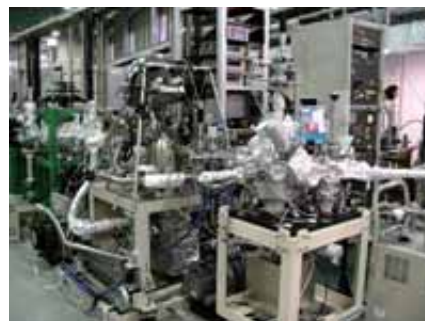
図 8 BL12 に設置された X 線光電子分光装置(左)と 2006 年度に新たに整備された X 線吸収スペクトル測定装置 (右)
