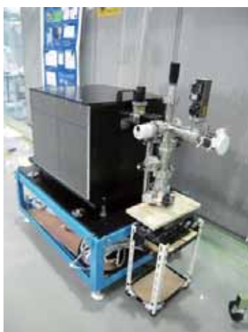
図 9 溶液の吸収スペクトルを測定するために開発された軟 X 線吸収分光装置
