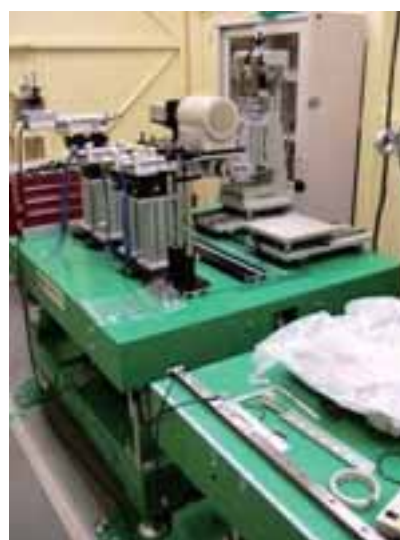
図 16 BL15 に設置された X 線小角散乱用ステージ
