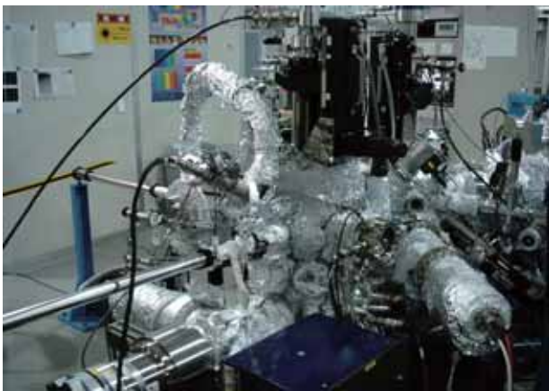
図 11 高分解能光電子分析装置
