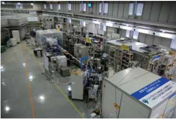
図 10 BL13 の全体写真。手前がレーザーブースで、 上流（写真の左上）がVLS分光器
