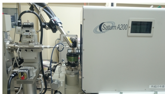
図4 高度化後のタンパク質X線回折装置における試料-検出器の周辺の様子（BL07）
