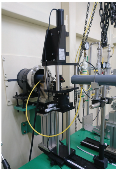
図 4 BL07 に設置した光軸調整用レーザーユニット
