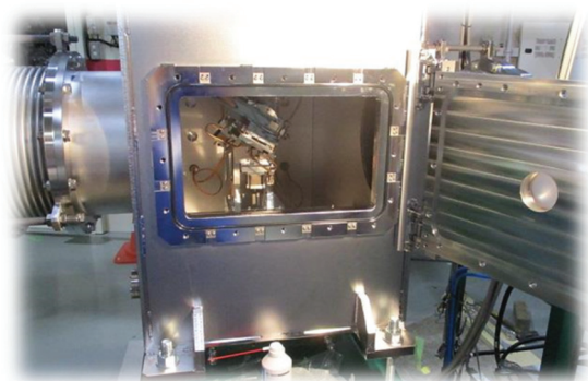
図3 ビームライン途中に設置されたSi(111)チャンネルカット分光器。Si(111)チャンネルカット結晶は、光軸上に出し入れが可能である。
