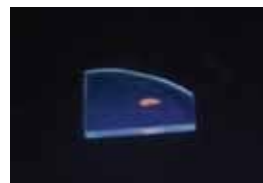
図3 Ag \text{L}_3 端XANES測定後のFD-7ガラスに対して、紫外線を照射し撮影した写真
