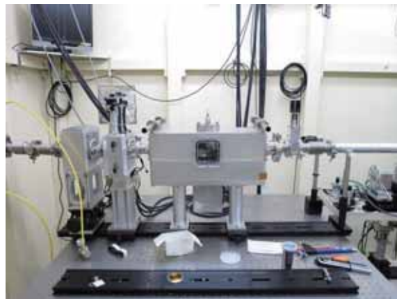
図1 BL11 第2実験ハッチ上流側の架台に設置した高調波除去ミラーシステム。
