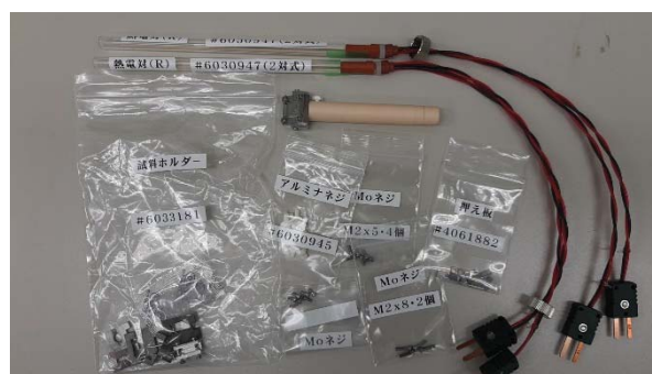
図7 更新したBL09高温加熱器耐熱試料ホルダーと熱電対
