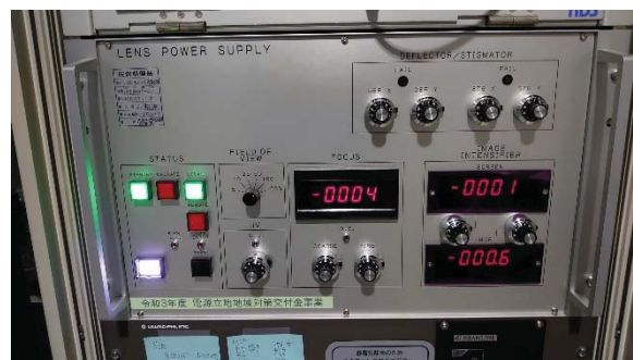
図6 更新したPEEM高電圧電源
