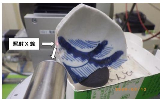
図 1. 三重津海軍所跡から出土した灘越蝶文染付皿(899SHK-21\_0154)のシンクロトロン光蛍光 X 線分析。赤いレーザー光の箇所に X 線が照射され、蛍光 X 線が手前の検出器に達し、蛍光スペクトルが得られる。
