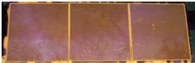
同一DFレジストの3箇所、このUVフォトマスクのマイクロパターン配列が転写された。ただし、各領域間には、 $2\text{mm}$ のスペースを置いている。このスペースは、湾曲状DFレジストでの位置を計測するのに利用する。
