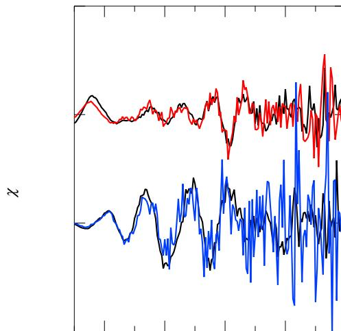
図1:熱処理を行ったGd<sub>65</sub>Ni<sub>35</sub>金属ガラスのGd L<sub>III</sub>およびNi K吸収端付近で得られた $k^3\chi(k)$ スペクトル。黒線は、よくアニールされた同じ試料の測定データを示す。
