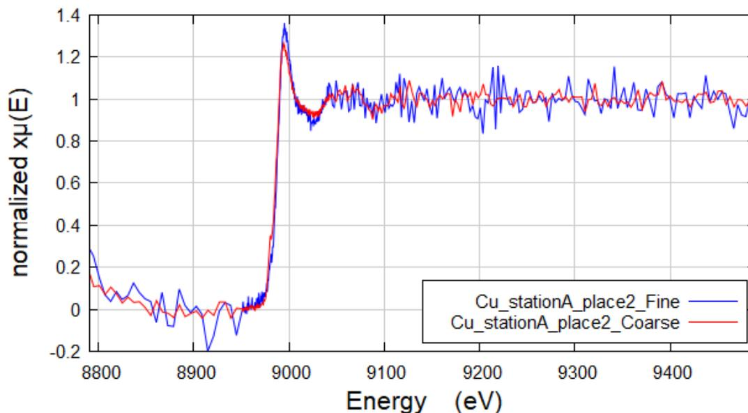
図 3. A 駅の地下鉄構内の同地点で採取された微小および粗大粒子中 Cu の XANES スペクトル
