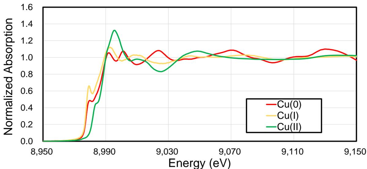
図 1. Cu 標準試料の XANES スペクトル
