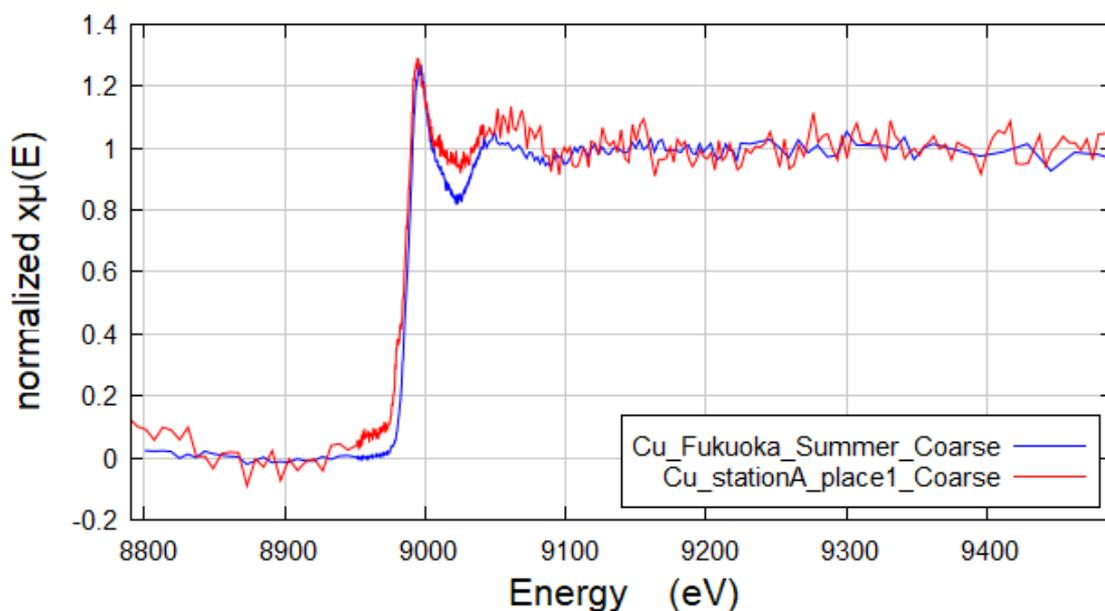
図 2. 大気粒子および A 駅の地下鉄構内で採取された粒子中 Cu の XANES スペクトル
