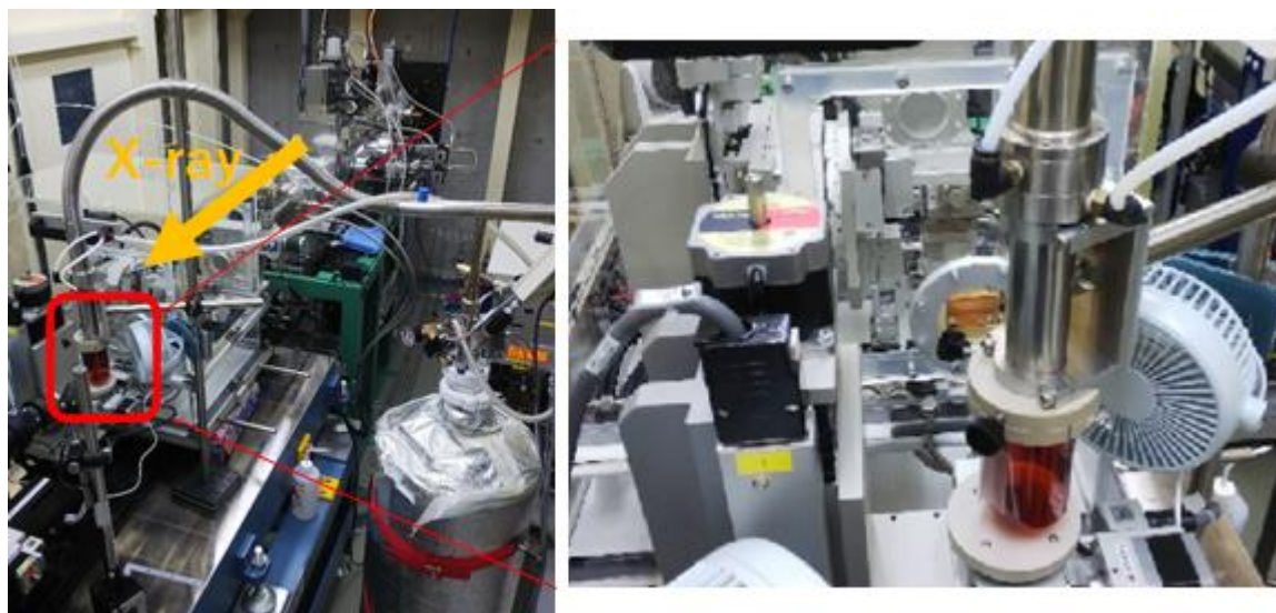
図3 試料温度制御 X線CT 左：全体の構成、右図：試料冷却部拡大図
