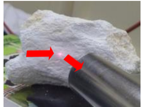
図 1. 陶石のシンクロトロン蛍光 X 線分析測定。レーザー光で光っている箇所に X 線が照射され、蛍光 X 線が手前の検出器に達し、蛍光 X 線スペクトルが得られる。
