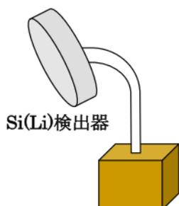
シンクロトロン光研究施設で実施した 17 世紀から 19 世紀に有田・伊万里で製造された肥前色絵磁器の色絵釉・透明釉の物性・素材研究が記載されている。この実験では、これらの磁器の色絵釉および透明釉から放出された蛍光 X 線による XAS が高精度に測定されている。左図は、この実験で使用した簡易型の Si (Li) 型半導体検出器の概容を示す。この検出器は大きな X 線フォトン受光窓をもち、マグネット台座にセットされている。従って、試料表面近くに自由にセットして、試料からの微弱 X 線フォトンが収集できる。この様な小型 Si (Li) 型半導体検出器の利用が望まれる。
