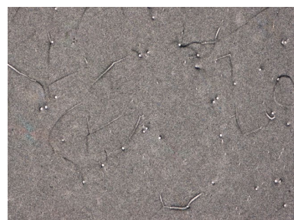
Fig. 2. 6 インチ SiC ウエハの X 線トポグラフィ像。
