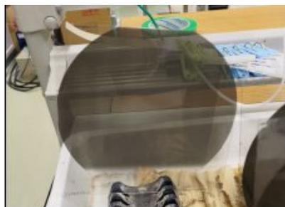
Fig. 1. 6 インチ SiC ウエハの X 線トポグラフィ像を撮影した原子核乾板。
