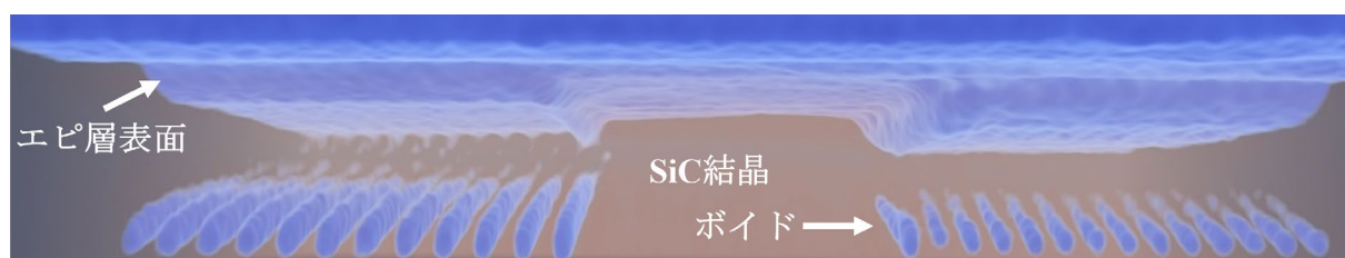
図2 トレンチ端部を内部可視化した3D構造図
