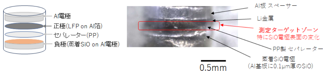
図2 X線CT用リチウムイオン電池模擬試料 (左) 概念図、(右) 実物側面写真
