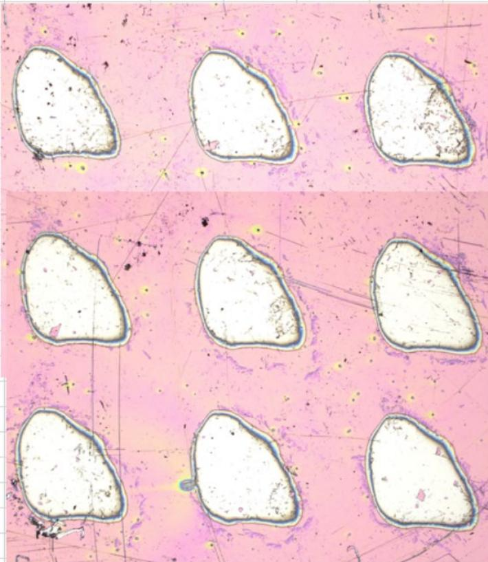
※すべてのポイントで露光量が大きすぎて完全に抜けている
