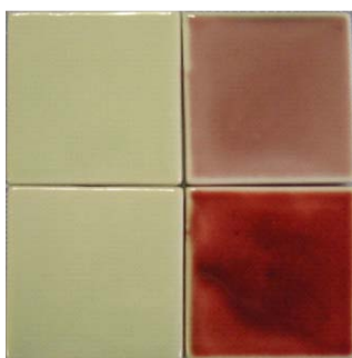
図 1 銅釉発色の焼成条件および再加熱の影響(CA 釉)
