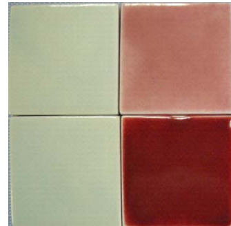
図 2 銅釉発色の焼成条件および再加熱の影響(BA 釉)
