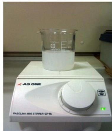
図1 ゲル化した $\text{Ga}(\text{NO}_3)_3$ 水溶液の写真。
