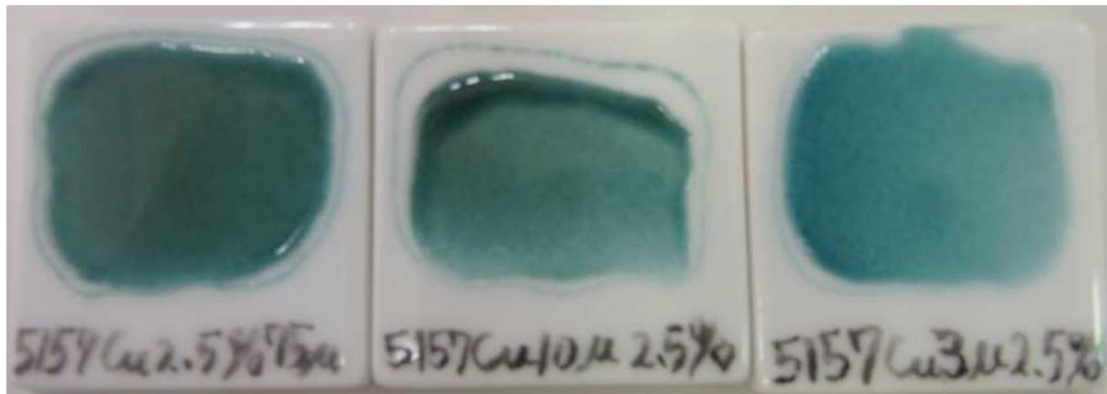
図4 粒径変化による銅上絵の発色変化.
