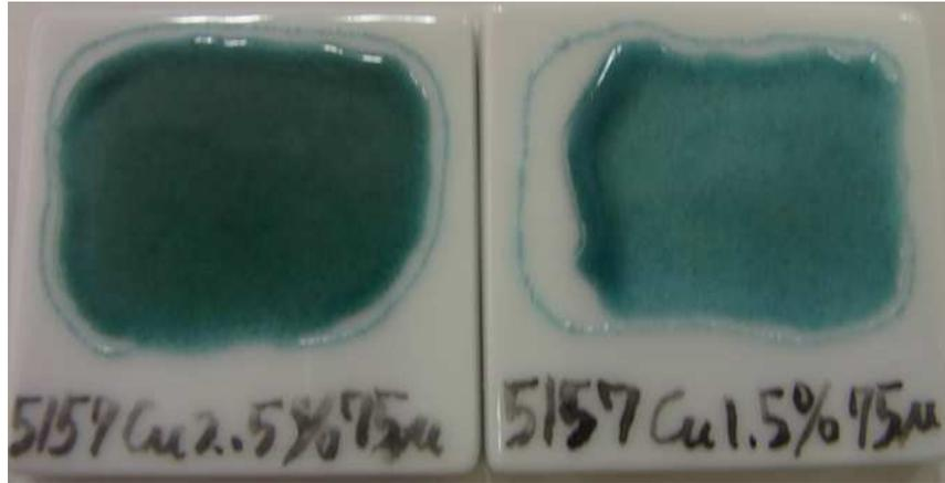
図3 金属銅添加量の変化による銅上絵の発色変化.
