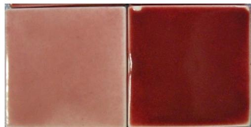
図 2. 辰砂（銅赤釉）の再加熱による発色変化
