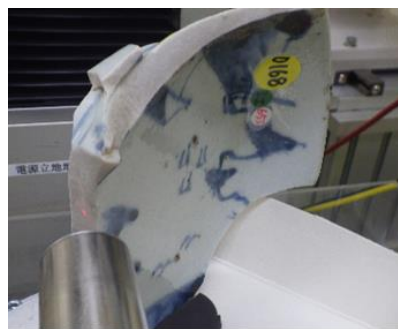
図1. 三股本登窯跡（長崎県長崎県東彼杵郡波佐見町）から出土した小皿のシンクロトン蛍光X線分析測定。レーザー光で光っている箇所に分光されたX線が照射され、蛍光X線が手前の検出器に達し、蛍光X線スペクトルが得られる。
