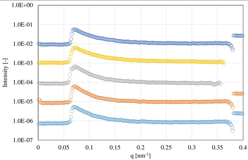
Fig.2-1 SAXS 分析結果(Pre-RPP210°C2 分急冷条件(Q), カメラ長 : ~2,500mm, R-AXIS)
