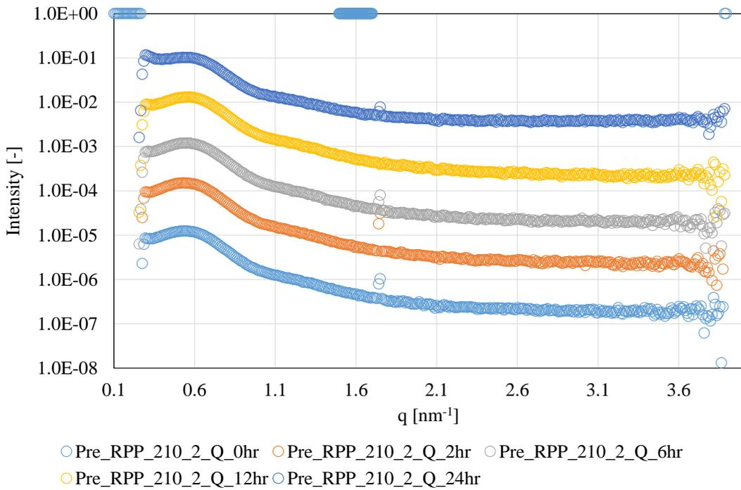
Fig.2-2 SAXS 分析結果(Pre-RPP210°C2 分急冷条件(Q), カメラ長 : ~750mm, PILATUS)
