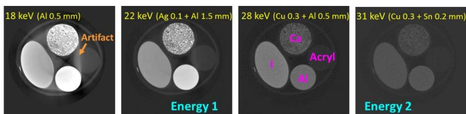
(a) 生体模擬ファントムの準単色X線CT断面像(計測画像)
