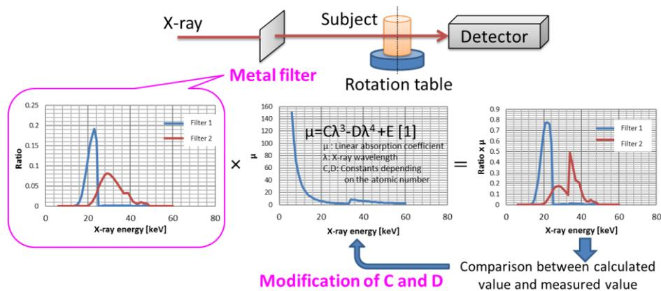
図3 デュアルエネルギーX線計測法
