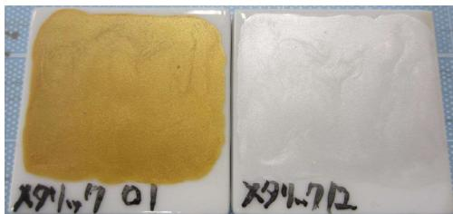
メタリック塗装と同様に雲母(マイカ)系光彩顔料を用いた雲母金・銀上絵は、雲母の反射による光彩があるが、表面の光沢がなく(マット)、塗面の光沢が強いメタリック塗装とは質感が異なる。
