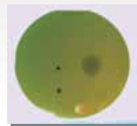
図4 2インチ径、0.4 mm厚の4H-SiCウェハ写真。
