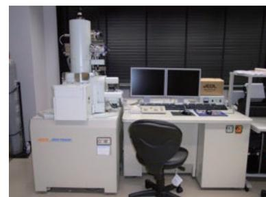
設備機器の紹介①: 走査型電子顕微鏡
