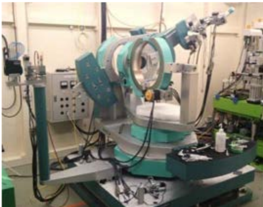
図 1. 大型多軸回折計 (HUBER 製：6-Circle Diffractometer 5021)
