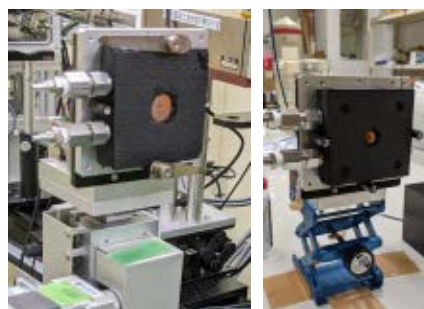
図8. 試料温調装置。固体試料用 (左) と液体試料用 (右)
