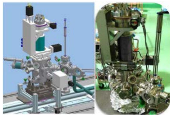
図6. 新規開発の Tender XAFS 測定用チャンバー
