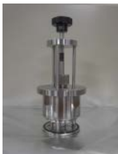
図9. 簡易型試料搬送導入装置
