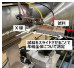
図2 小角 X 線散乱（SAXS）測定状況
